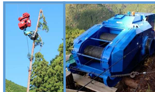
油圧式集材機・架線式グラブルの操作実習
