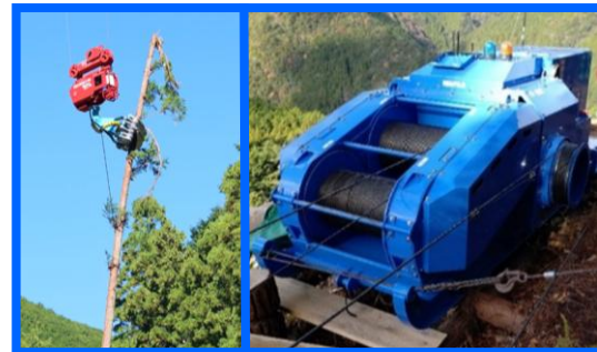
油圧式集材機・架線式グラブルの操作実習
