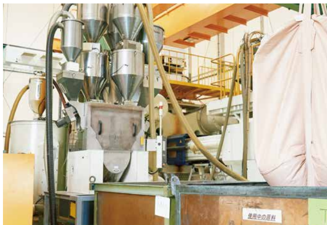
▲リサイクル素材がバージンプラスチックと混合される
