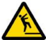
転落注意 Caution, drop [注]文字による補助表示が必要
