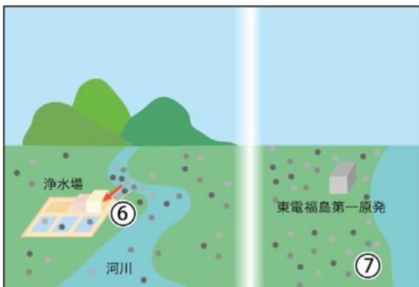
放射性物質を含む河川水が水道原水の取水口に流入。
