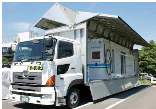
写真:徳島県移動式水素ステーション
