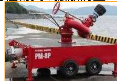
放水砲 (3台/3・4号機)
