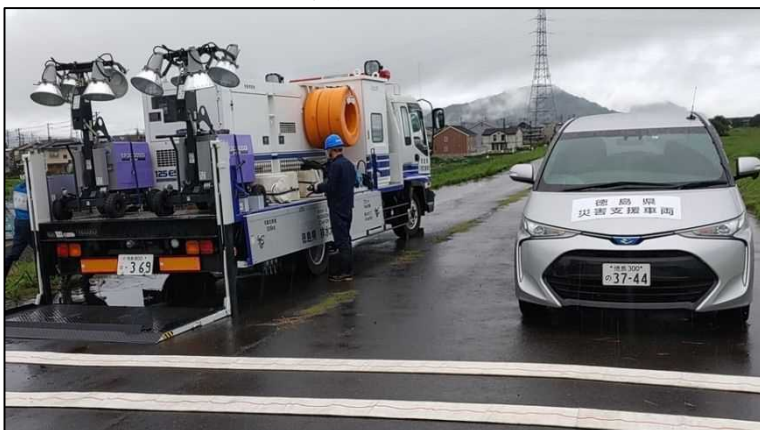
徳島県による排水ポンプ車支援の様子 (7/8 鳥取県鳥取市 清水川排水機場周辺)
