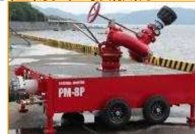
放水砲 (3台/3・4号機)
