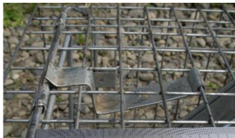
捕獲後、わなの扉が開かないようにするストッパー機能の付いたわなを選びます。
