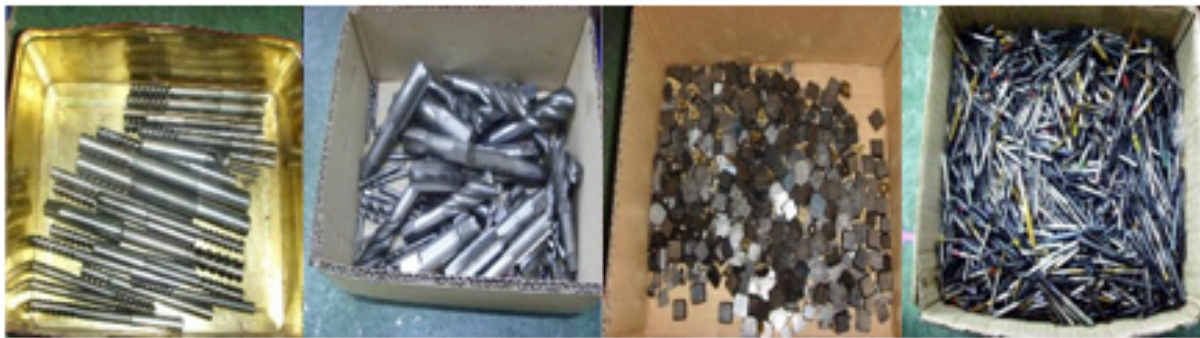
使用済み 超硬工具類(レアメタル)の分別保管
